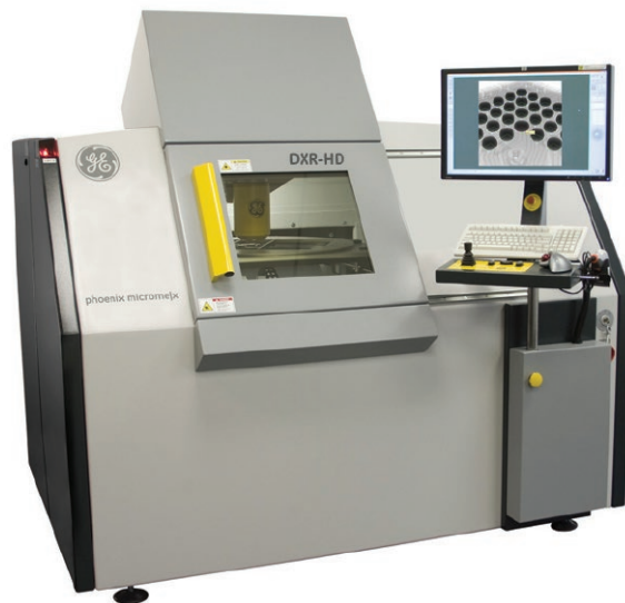
实时CAD数据匹配下的BGA锡球开路和Flash!Filters TM 影像优化
