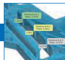
喷射器铸件3D图像, 可显示 细节特征。
