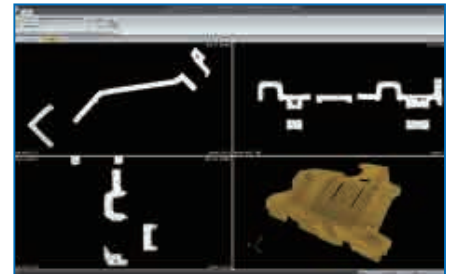
可视化datos|x软件，清晰显示CT结果的2D切片和3D渲染模式
