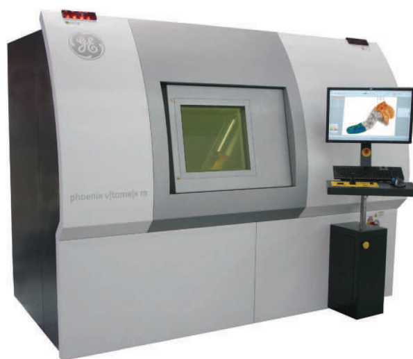
铝发动机缸盖3D测量，实际量测结果与CAD设计自动比对及偏差分析
