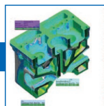
铝发动机缸盖3D测量，实际量测结果与CAD设计自动比对及偏差分析
