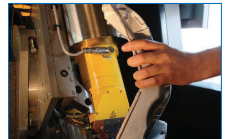
独有的300kV微焦点X射线管，可3D扫描更大尺寸或更大射线衰减率的试件
